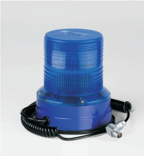
Die speziell für dieses Produkt entwickelte Leistungs- und Steuerelektronik ist vollständig in einem Aluminium-Gehäuse-unterteil integriert. Eine Fresneloptik optimiert den Wirkungsgrad der Blitzleuchte. Die Optik ist so ausgelegt, dass selbst bei einer Schräglage (Missweisung) von bis zu +/- 10° aufgrund der Dachneigung des Fahrzeuges, die geforderten Lichtwerte von 42 cd für 0° eingehalten werden.
